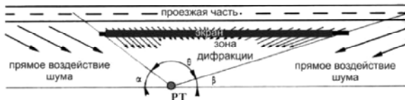
Рис. 3. Схема проникновения звуковых волн в область за шумозащитным экраном (ИШ – источник шума, РТ – расчетная точка) [1].
