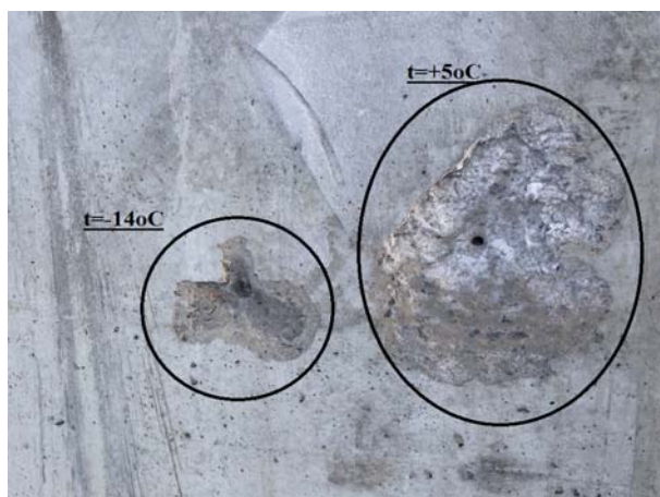
Рисунок 2. Вид отрыва при -4 оС и +5 оС
