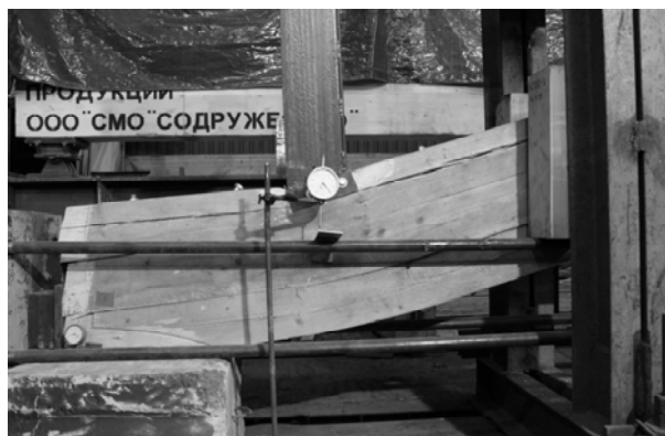
Рис. 12. Разрушение опорной части.
